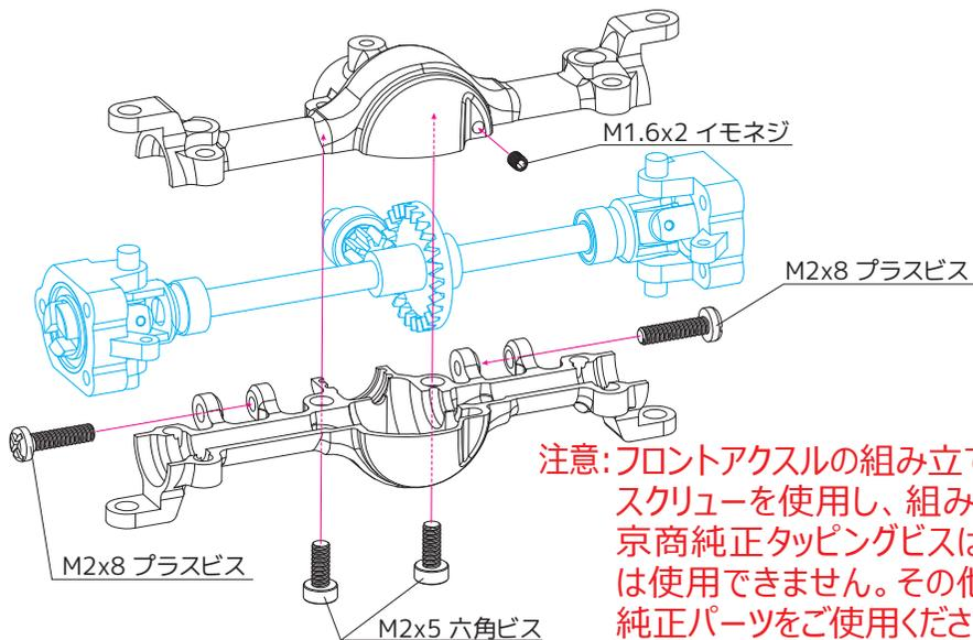
**注意:**フロントアクスルの組み立てには必ず同封スクルーを使用し、組み立てて下さい。京商純正タッピングビスはアルミパーツには使用できません。その他組み立てには純正パーツをご使用ください。
